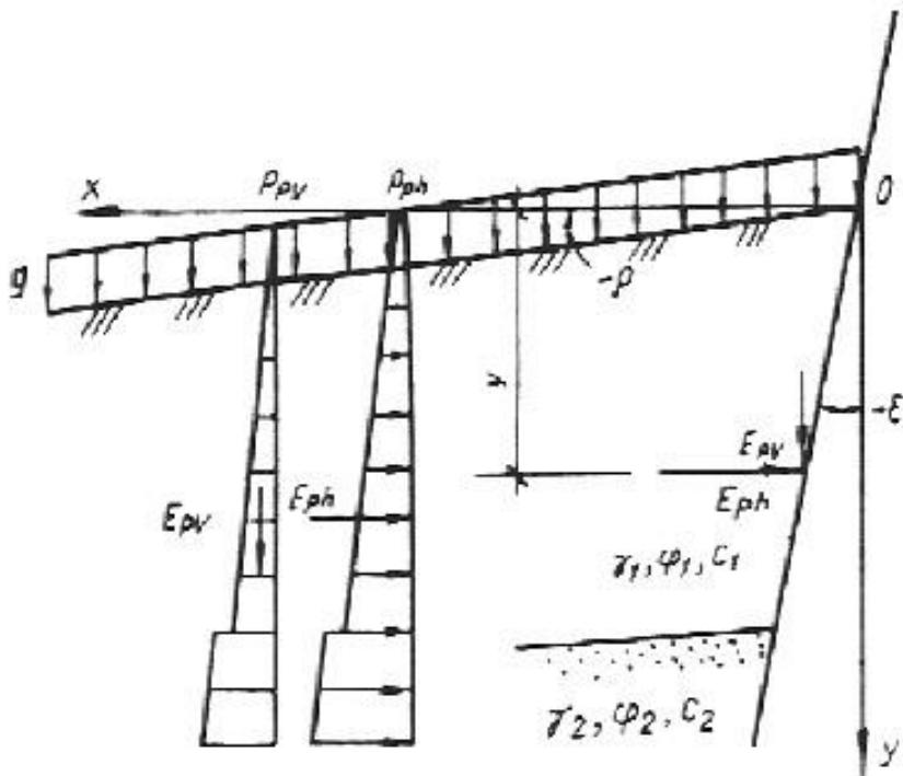
Черт.3. Схема к расчету пассивного давления грунта
