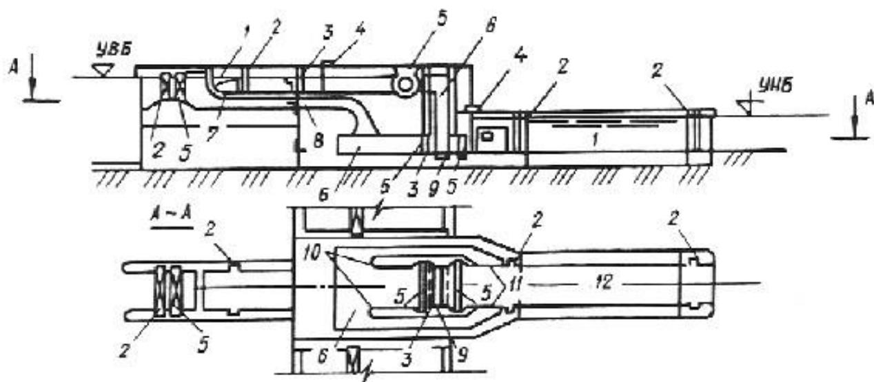
Черт.5. Рыбоподъемные сооружения. Гидравлический рыбоподъемник
