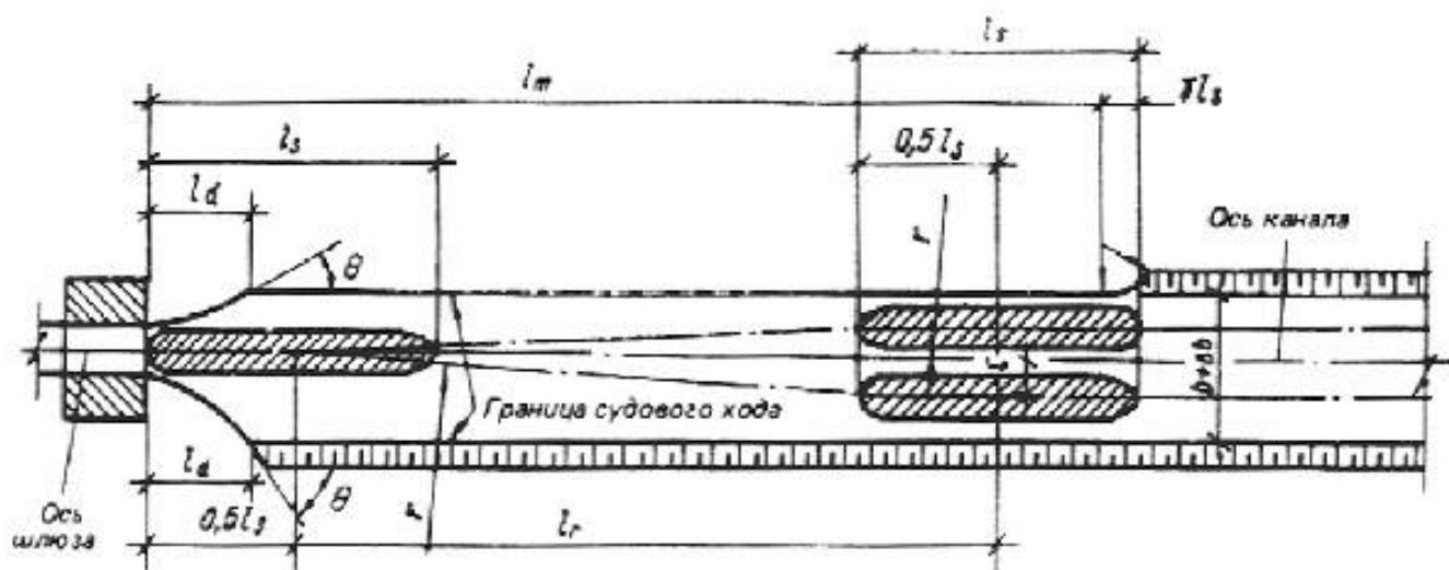
Длину причальной линии на водных путях местного значения допускается уменьшать при одностороннем движении судов до размеров полезной длины камеры шлюза; при двустороннем движении судов - до размеров полезной длины камеры шлюза, но с размещением начала причальной линии от внешней грани головы шлюза на расстоянии  $l_r$ , в пределах которого следует предусматривать устройство направляющего сооружения и отдельно стоящих причальных сооружений (быки, свайные кусты и др.).
