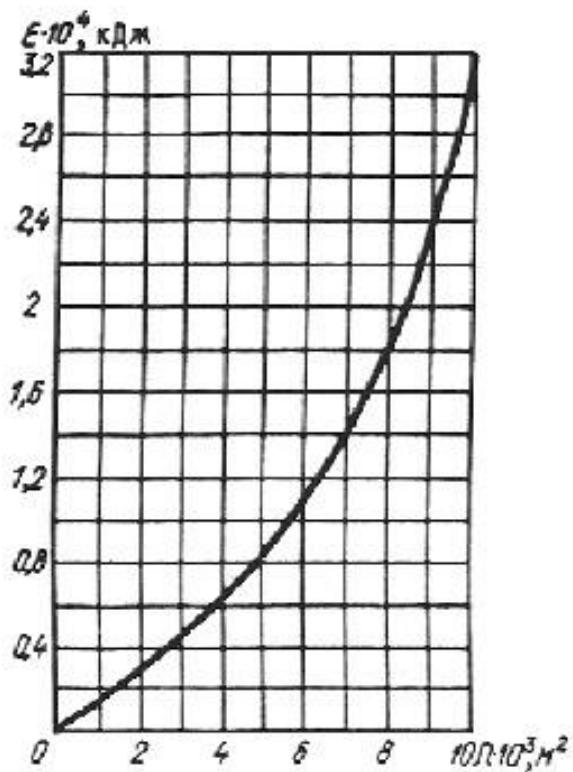
Черт.4. График для определения энергоемкости предохранительного устройства
