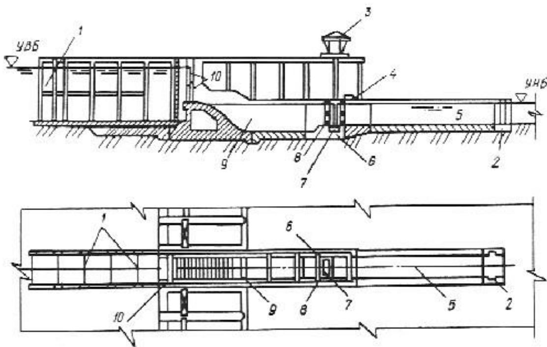
Черт.6. Рыбоподъемные сооружения. Механический рыбоподъемник
