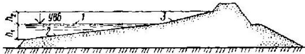
Определение крутизны верхового неукрепленного откоса песчаной плотины
