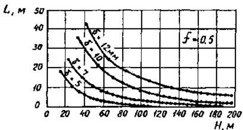
Черт. 1. Зависимость расстояния между горизонтальными швами диафрагмы по высоте  $L$  от толщины диафрагмы  $\delta$ , величины коэффициента трения грунта по диафрагме  $f$  и высоты диафрагмы  $H$
