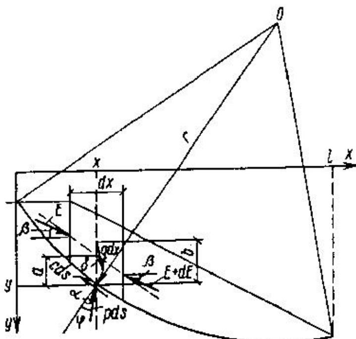
Схема сил, действующих на элемент призмы обрушения
