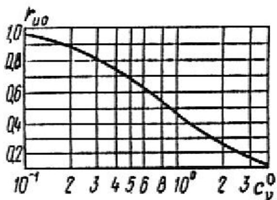
Черт. 3. График зависимости коэффициента порового давления  $r_{u0}$  от  $c_v^0$
