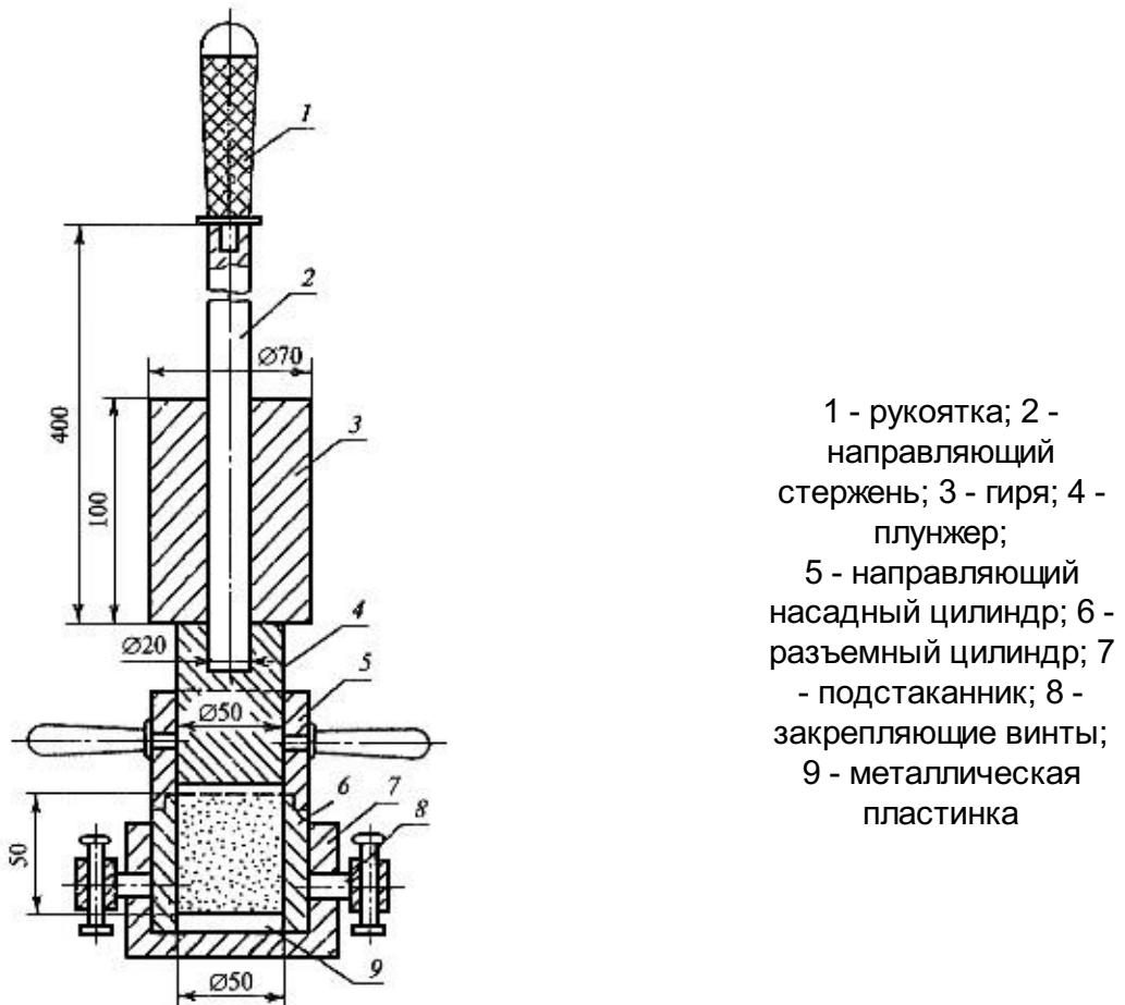
Рисунок 14 - Малый прибор Союздорнии для стандартного уплотнения
