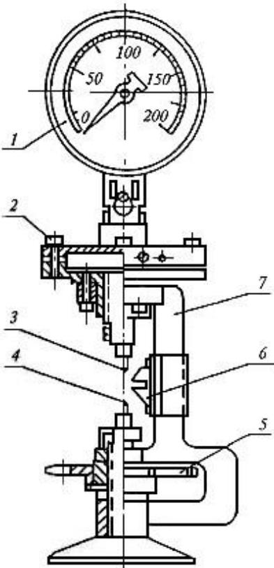
1 - манометр; 2 - гидравлическая мессдоза; 3 - верхний зуб; 4 - нижний зуб;
