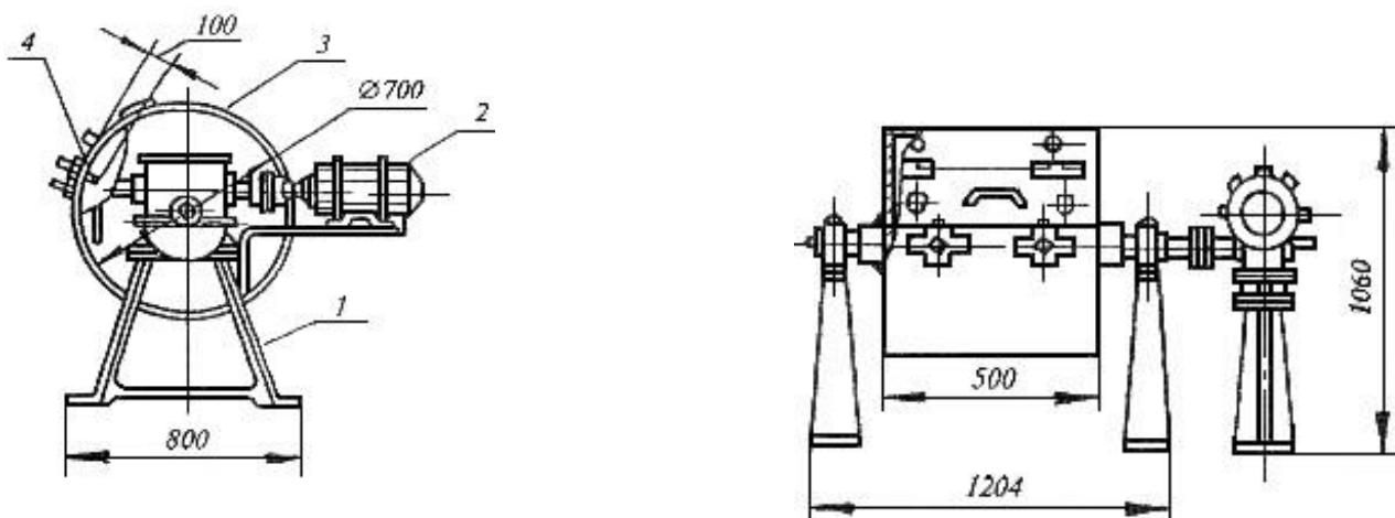
1 - станина; 2 - двигатель; 3 - барабан; 4 - полка барабана
