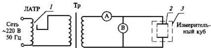
1 - лабораторный регулировочный трансформатор (ЛАТР); 2 - электрод; 3 - измерительный куб
