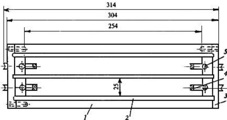
1 - форма; 2 - боковые стенки формы; 3 - торцевая стенка формы; 4 - репер; 5 - стопорный винт для крепления репера; 6 - держатель репера
