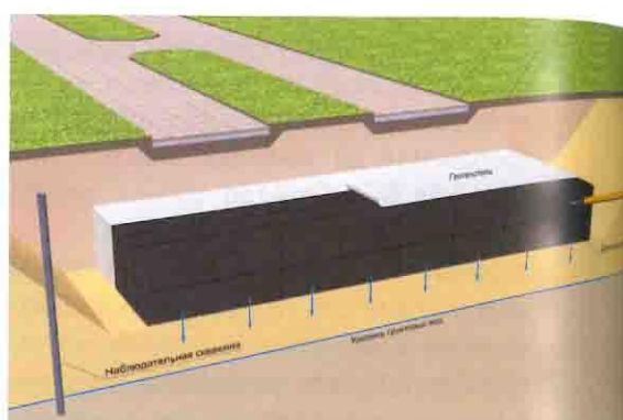
► Рис. 2. Схема подземного сооружения из пластиковых инфильтрационных блоков
