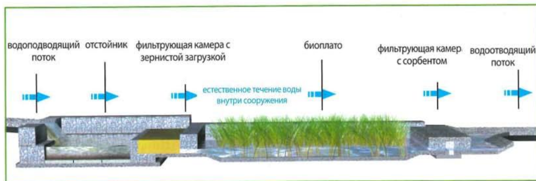
Рис. 3. Принципиальное устройство ГОФС
